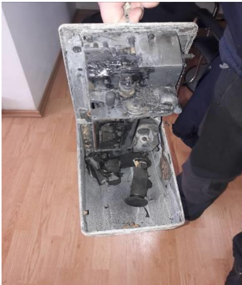
Foto nr.8 – vitezometrul degradat
